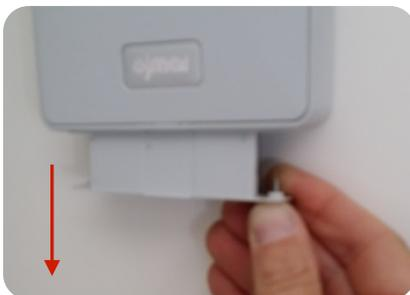
3. Sustituir las pilas y volver a colocar el portapilas.
