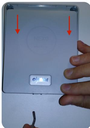
5. Atar el portapilas con los dos tornillos.
